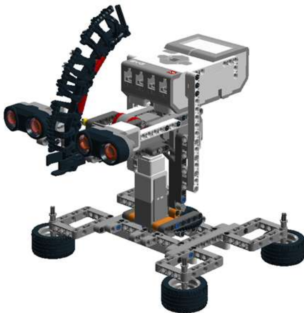
Рисунок 2.1.2.1. Конструкция робота, способного обнаружить объект, следить за ним и поражать шариками на заданном расстоянии
